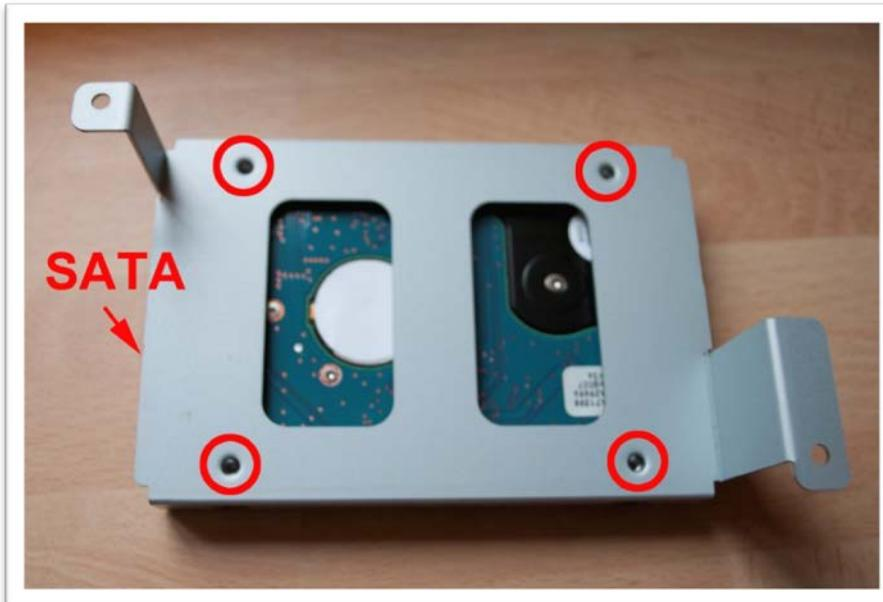
4. Skruva nu tillbaka hårddisken på. Anslut nu strömkabeln från nätdelen i mottagaren samt anslut den röda SATA-kabeln som följe med. Efter slutförd montering:
